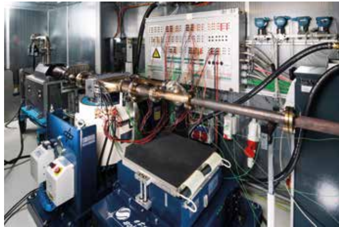
Abbildung 26: TEG für ein Nutzfahrzeug mit rund 2700 W gemessen auf dem Heißgasprüfstand Quelle: DLR FK Stuttgart
